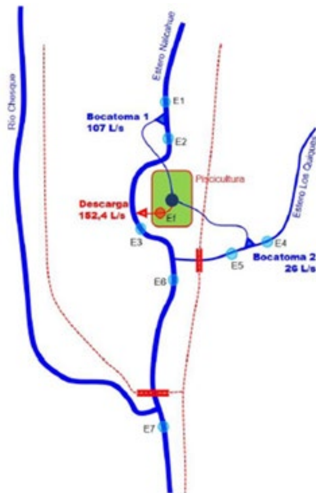
Figura 2. Diagrama que muestra la conformación hidrológica del área de estudio, donde se observa la existencia de las 3 cabeceras o headwaters que debieron considerarse en la modelación. Modificado del "Modelo conceptual del área de estudio" del Proyecto (fs. 4352).
