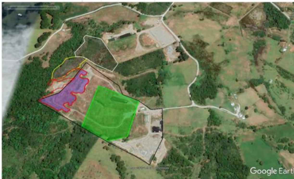
Figura N° 18: Área de intervención del proyecto Vertedero Dicham estimada por la SMA en su resolución sancionatoria. En verde se presenta el área contenida en el cambio de uso de suelo, en amarillo y blanco el bosque nativo anegado, en rojo el bosque talado, dentro de la cuál se encuentra el área lila que corresponde al área del bosque talado que se encuentra dentro del área intervenida por el proyecto y en negro área de intervención del proyecto. Fuente: Res. Sancionatoria (Fs. 7031)
