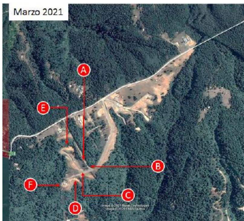
Figura 3. A fs. 475, Informe SERNAGEOMIN. Según se describe, Sector "F" indica presencia de taludes artificiales que coinciden con sector de remoción en masa antigua. Fuente: Fragmento de Fig. 14 en Informe de SERNAGEOMIN (fs. 475).
