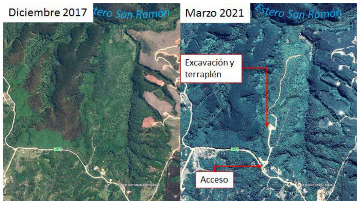
Figura 29. Comparación del estado de la zona del loteo El Canelal entre 2017 y 2021, mediante imágenes aéreas. Fuente: Informe Técnico de SERNAGEOMIN (fs. 469).
