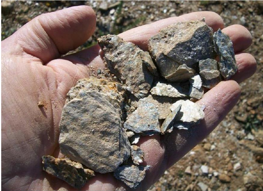
Figura 1. Roca meteorizada (esquisto pelítico meteorizado) que se desintegra en fragmentos muy pequeños y material arenoso/ferroso. Fuente: Documento "Línea de Base. Geomorfología, Hidrología, Geología e Hidrogeología, Predio Cutipay 1", elaborado por Amest, Joachim Zora, Geólogo, Mayo de 2024 (fs. 9963).
