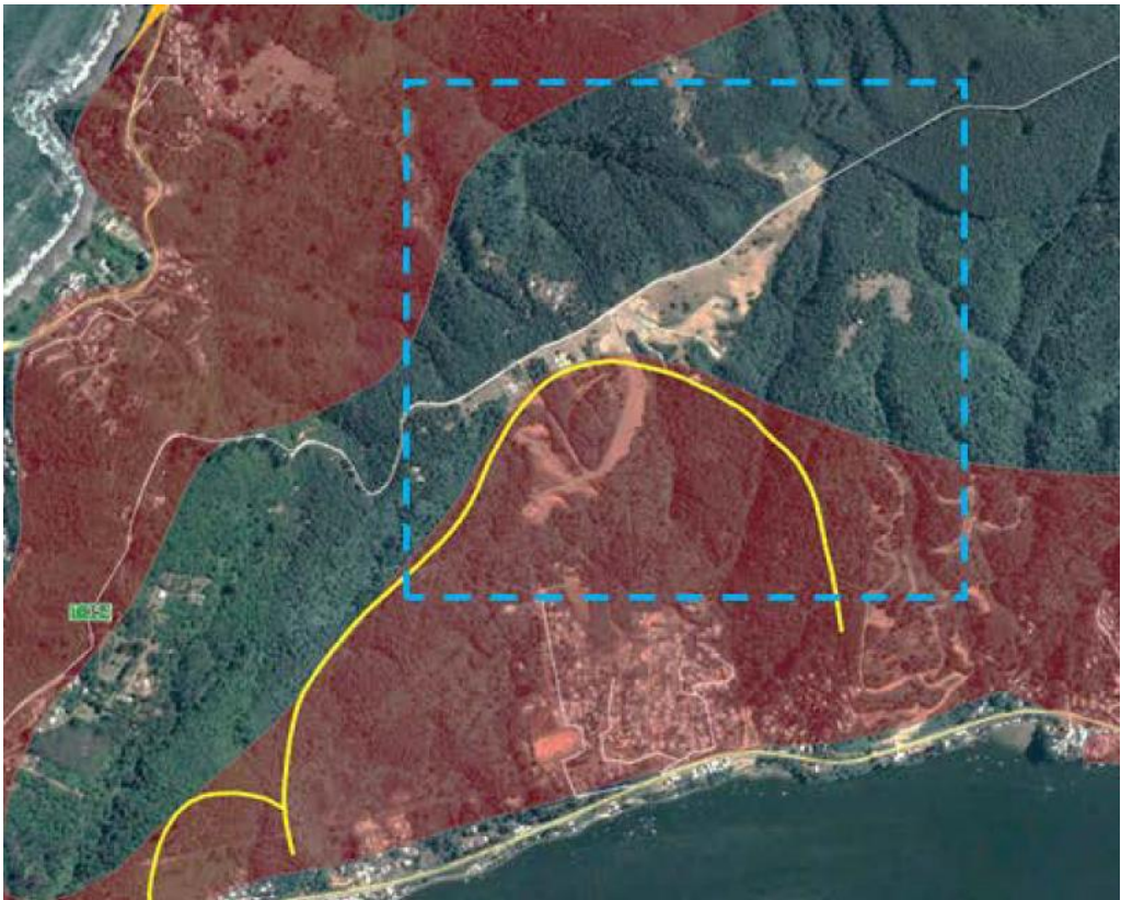
Figura 2. Loteo de Altos de Cutipay y su relación con la zona de alto peligro de remociones en masa (modificado de Arenas et al., 2005). Líneas amarillas
